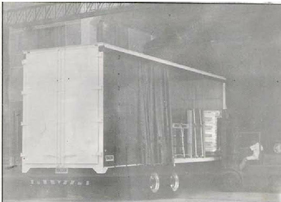
Com a carroceria Sider, há enorme facilidade para carga e descarga, feita pelas laterais
