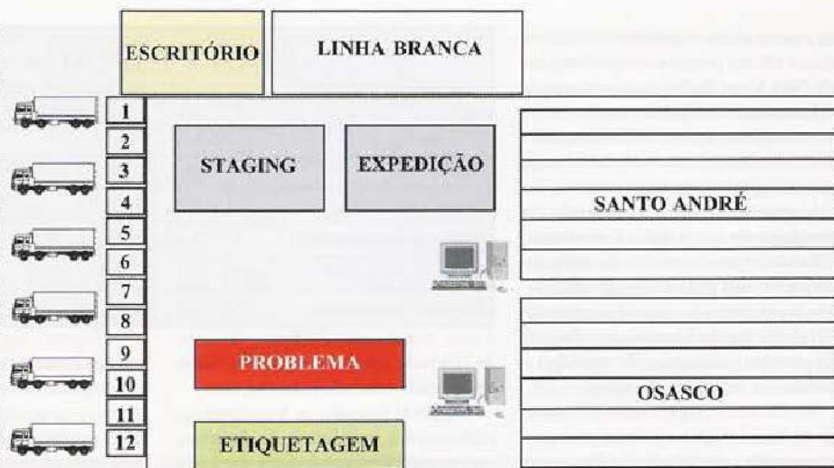
O armazém da Celsur, em Itapevi (SP), utilizado pelo Wal-Mart tem 12 docas. Após o recebimento (no chamado setor Staging), as mercadorias são separadas entre as que se destinam ao Supercenter de Santo André (SP) ou de Osasco (SP). Na entrada dos racks, um scanner ligado a um micro registra o palete e seu endereço. Os produtos que não possuem código de barras ou são importados passam antes pela Etiquetagem. Existe ainda uma área de problemas, para as cargas que apresentam alguma anomalia. Os itens de linha branca têm uma área específica no armazém.
