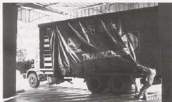
Caminhão dotado de carroceria tipo sider com portas lanadas: facilidade no carregamento e descarregamento.
