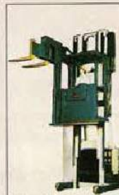
ESTL-10/15 Empilhadeira Trilateral e Seleccionadora de Pedidos Eleva o cabine com o operador até 8,5m de altura. Curso em corredores de 1,600m. Capacidade 1.500 kg. indicada para empilhamento e seleção de pedidos simultaneamente.
