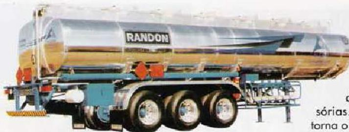
tipo botton loading, também conhecido como sistema lacrado de carregamento ou carregamento por baixo. Por isso, além de possibilitar maior rapidez na operação, elimina eventual liberação de gases na atmosfera. O seu formato é obtido pela tecnologia hidro-air-forming, empregada na fabricação das cabeceiras, quebra-ondas e
