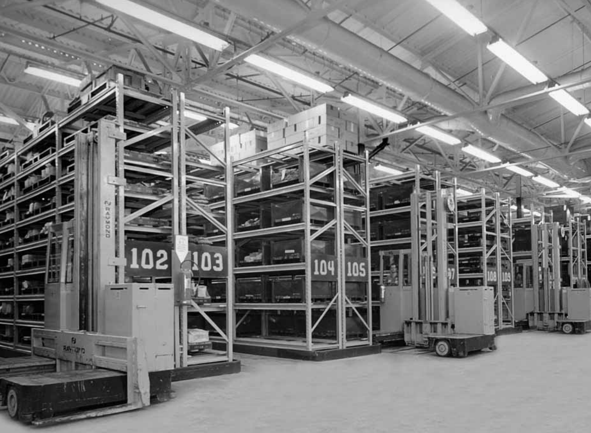
Sistema de armazenagem verticalizado com embalagem modular e empilhadeira lateral
