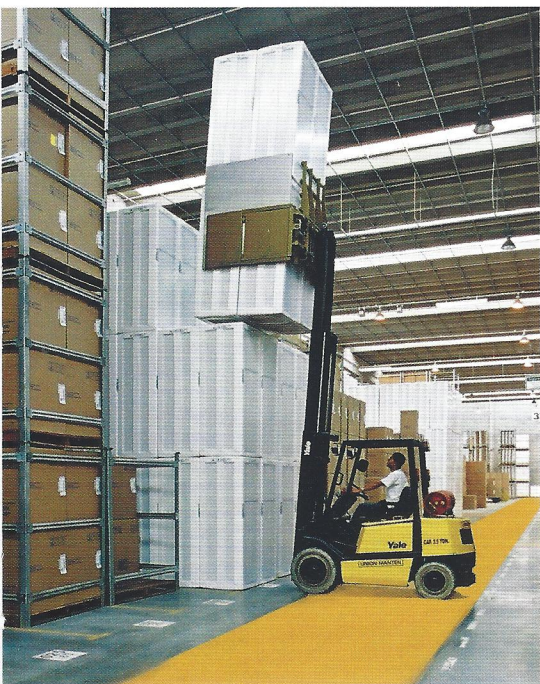
As embalagens foram reforçadas para permitir maior verticalização da armazenagem
