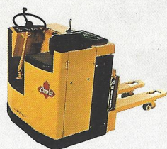
Transpallet Elétrico, modelo EKE. Capacidade: Até 1.600 Kg
