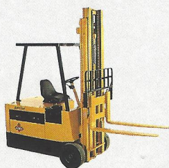
Empilhadeira Elétrica, modelo EFG. Capacidade: Até 1.500 Kg Elevação: Até 4,00m
