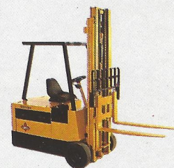
Empilhadeira Elétrica, modelo EFG. Capacidade: Até 1.500 Kg Elevação: Até 4,00m
